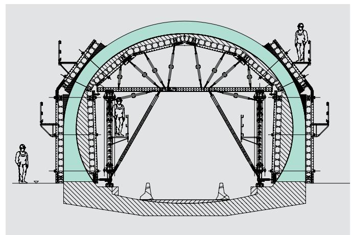
Kružni poprečni presjeci također su mogući kao zasebna kolica za pojedinačnu montažu zidova i stropova.
