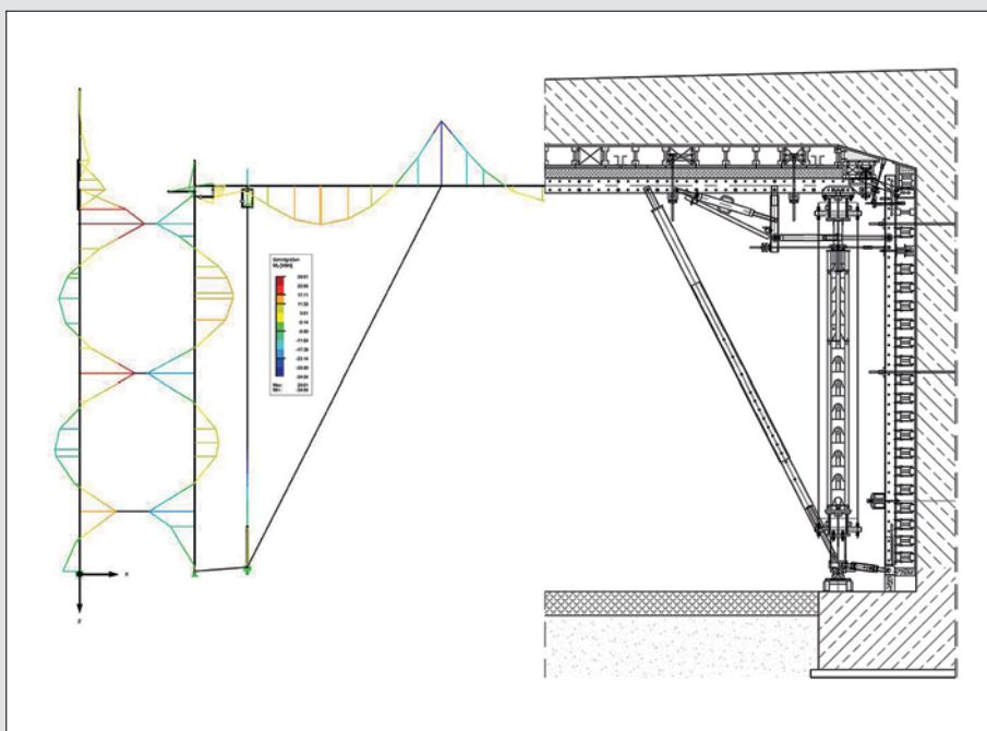
Projektiranje tunela s prikazom momentnih linija u sistemskim osima (lijeko) te poprečnog pre-sjeka (desno).
