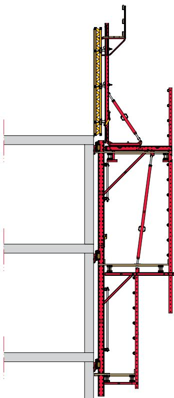
**Obje sistemske varijante po izboru se mogu penjati i hidraulički pa samim time i neovisno o dizalici.**
