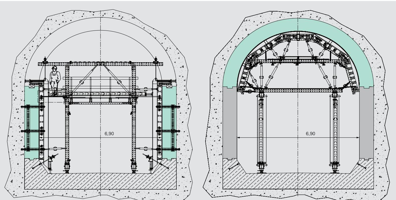
Kolica za transport iz sistema RCS prenose jedinicu za montažu i podupiranje u sljedeći takt.
