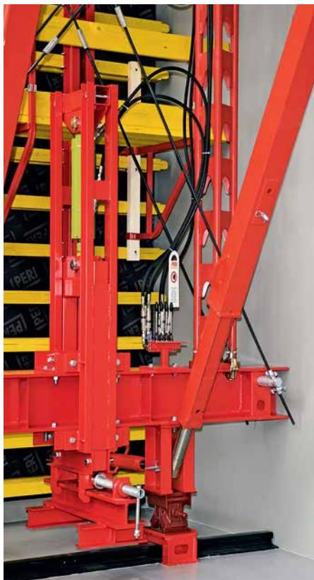
Opcija je i opremanje tunelskih oplata hidrauličkom jedinicom za podizanje i sruštanje.
