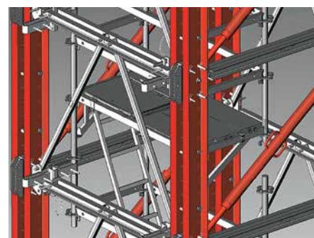
Modularnim sistemom skele PERI UP brzo se i sigurno slazu sva potrebna stepeništa, pristupi i radni podesti.
