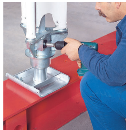
Uvjet je uobičajena bušilica s SW 19 (nikako udarni izvijač).
